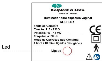
Figura 6 - Etiqueta do Transformador de Energia
